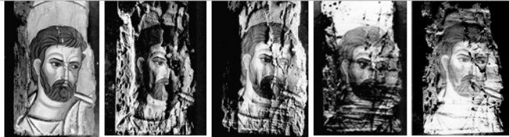
Εικόνα 4.2 Ζωγραφική σε ξύλο, πειραματικός πίνακας. (α) VIS με συμμετρικό φωτισμό, (β), (γ), (δ) και (ε) VIS με εφαπτόμενο φωτισμό κατά τις τέσσερις διαφορετικές κάθετες διευθύνσεις όπου σε κάθε διεύθυνση διακρίνονται διαφορετικοί τύποι φθορών και γεωμετρικών παραμορφώσεων (Προσωπικό αρχείο Α. Αλεξοπούλου).
